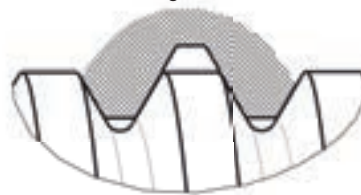
Profil mit verkürzten Flanken (abgesetzt)
